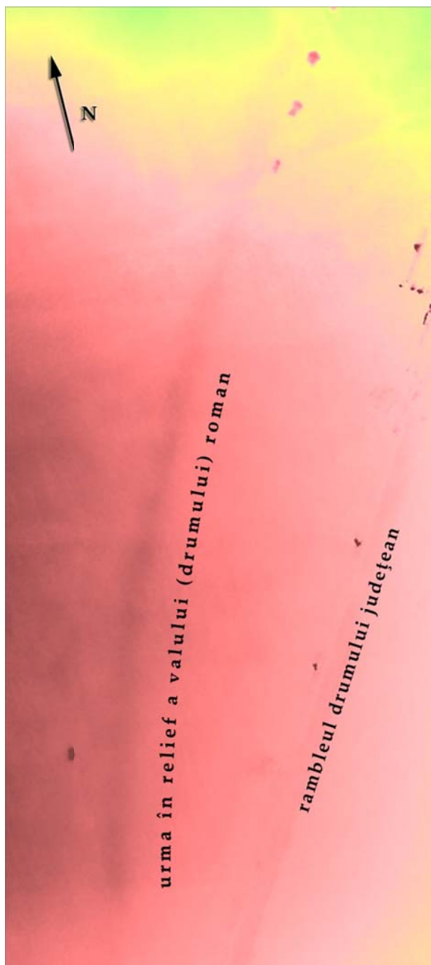
Figura 2.15. Model teren (DEM) obținut prin fotogrametrie, via UAV, imediat la vest de Spitalul de Pneumo-ftiziologie, Roșiorii de Vede.
