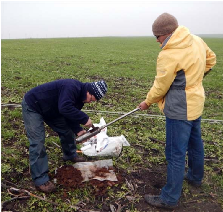
Figura 8.1. Sonda de soluri utilizată pentru carotaj.
